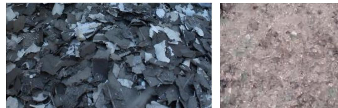
Figure 21 : Fragments de silicium et granulés de verre (source : Soren, 2015)
