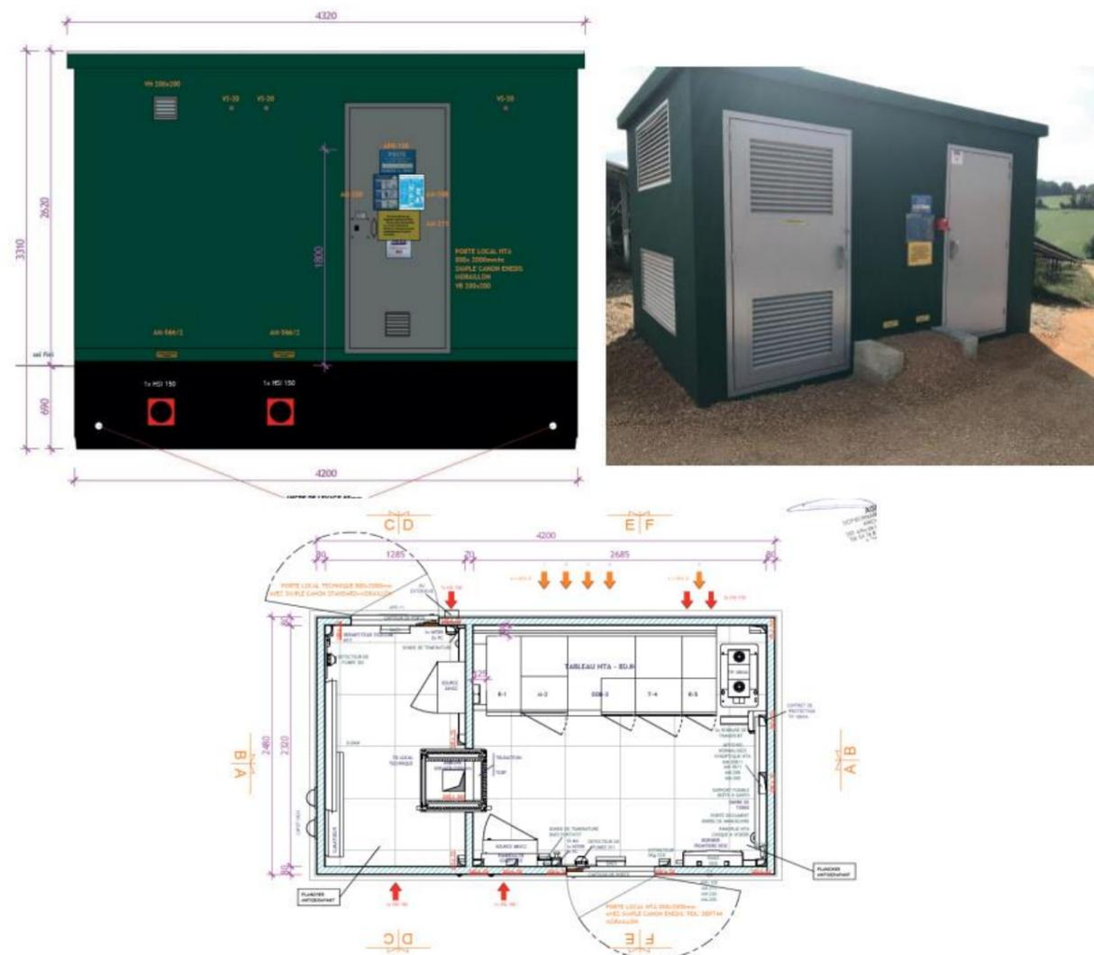
Figure 11 : Coupes de principe et illustration du poste de livraison envisagé (source : URBASOLAR, 2021)
