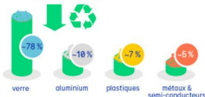
Figure 20 : Le traitement des panneaux photovoltaïques (source : Soren, 2022)
