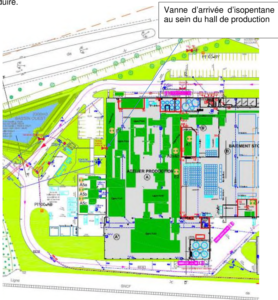
Figure 3 : localisation du hall de production et lieu de fuite d'isopentane considéré sur le site KNAUF ISBA d'Auxerre
