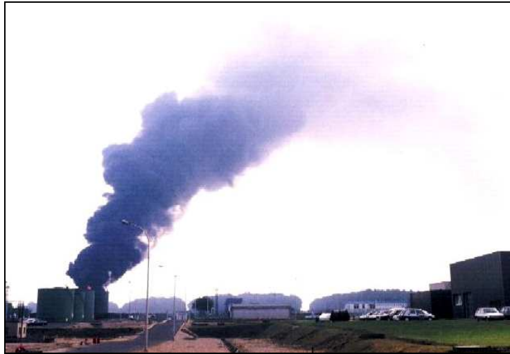
Ascension et dispersion d'un panache de fumées. Feu d'hydrocarbure du GESIP sur le site du CNPP.
