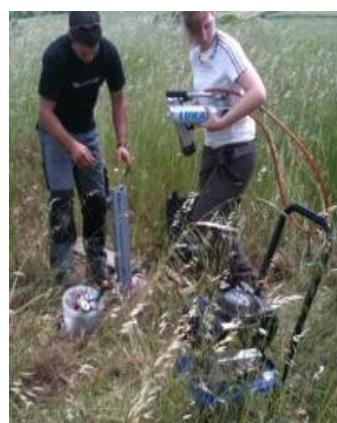
figure 12. Test de résistance à l'arrachage des pieux
