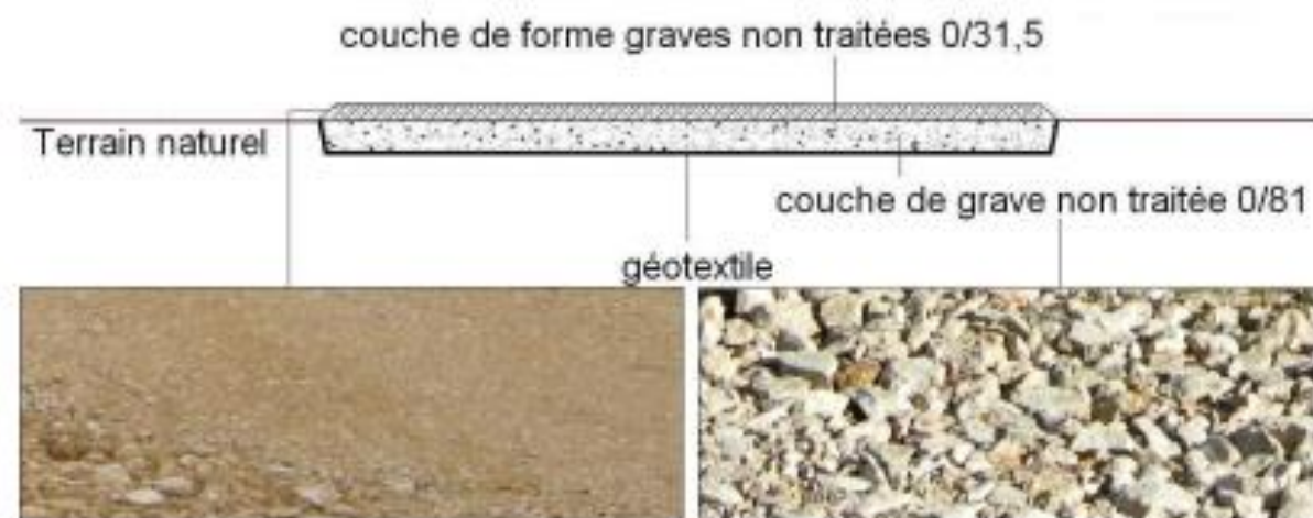
figure 117. Coupe de la voirie interne / Plateforme de travaux (Source : LUXEL, 2011)
