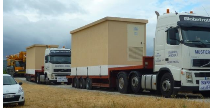
figure 24. Convoi exceptionnel : Transport des locaux techniques
