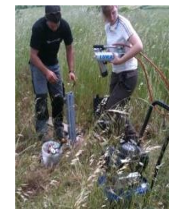
Test de résistance à l'arrachage des pieux
