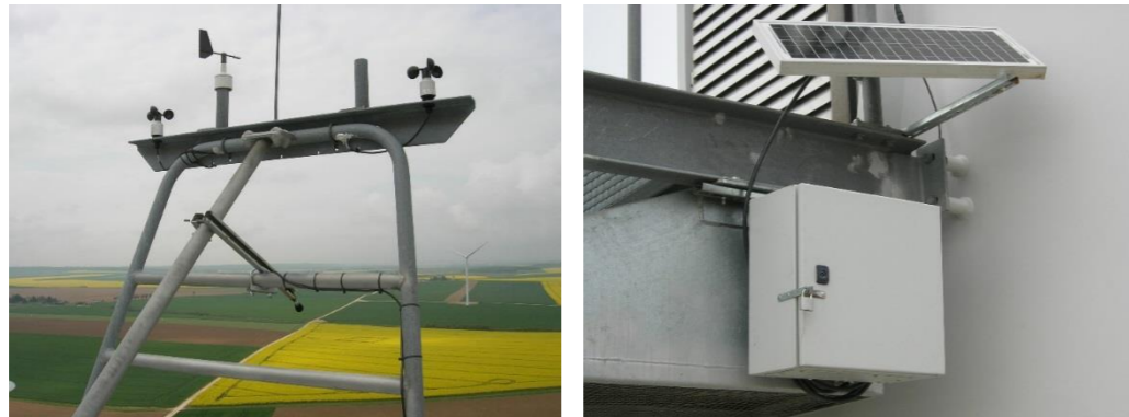
Figure 271 : Micro placé à 84 m de hauteur (photo de gauche) et boîtier avec l'enregistreur alimenté par un panneau solaire (photo de droite)
