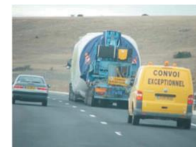
Figure 33 : Acheminement d'une nacelle par convoi exceptionnel jusqu'au chantier
