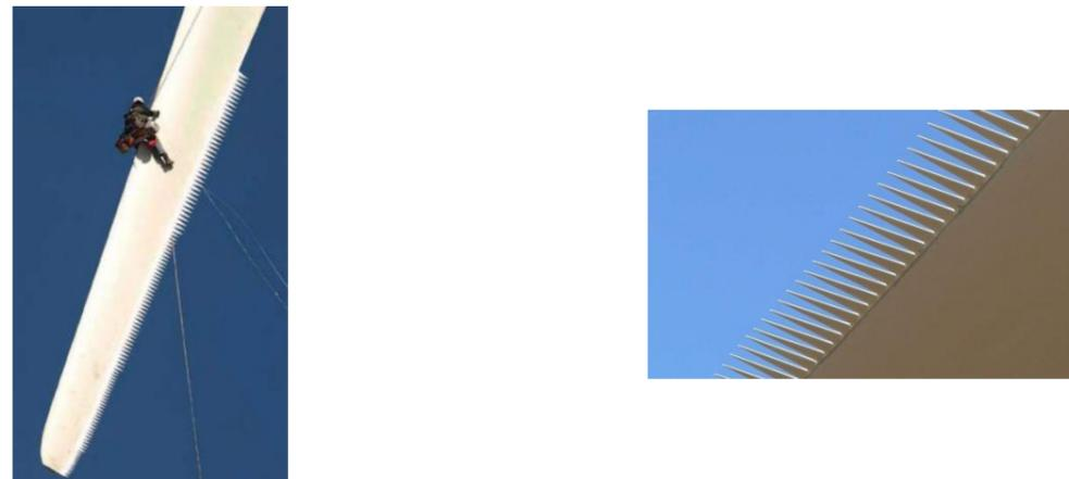
Figure 14 : Photographies d'une pale dotée d'un système STE (peigne / dentelure)
