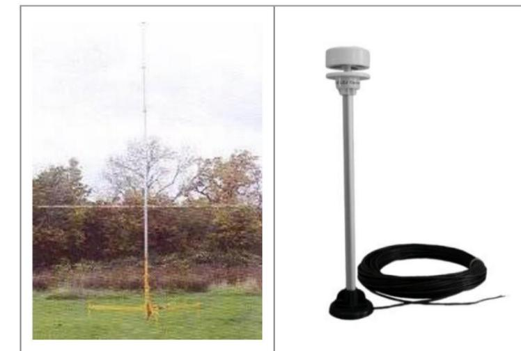
Les experts acousticiens recourent à un capteur girouette-anémomètre à ultrasons (LCJ capteurs) adapté aux mesures de vents horizontaux. Des transducteurs électroacoustiques communiquent deux à deux par signaux ultrasons, permettant de mesurer la vitesse et la direction du vent induit par le flux d'air selon deux axes orthogonaux.
