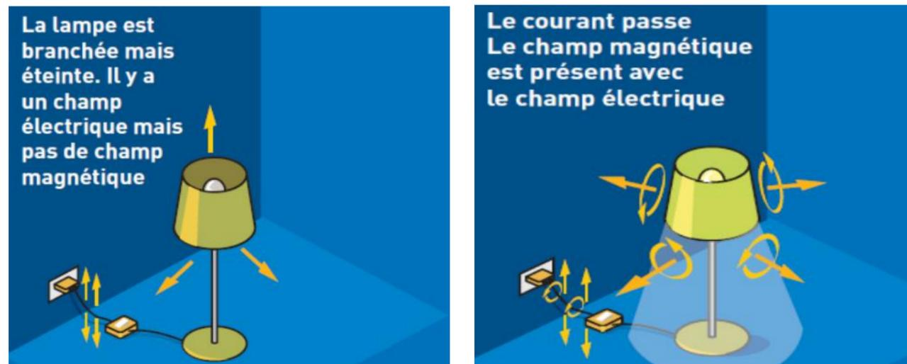
Figure 26 : Différence entre champs électrique et champ électromagnétique (Source : RTE)
