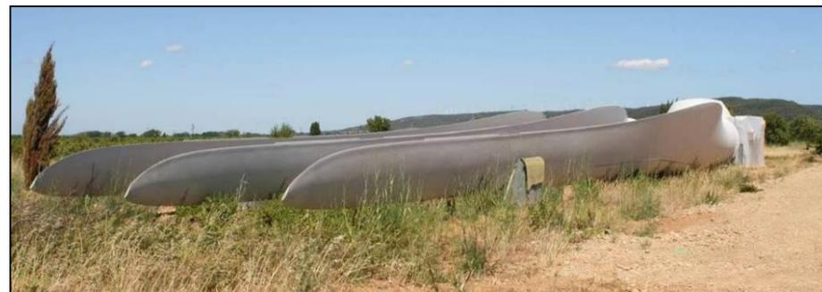
Photo 82 : Pales entreposées sur un chantier éolien
