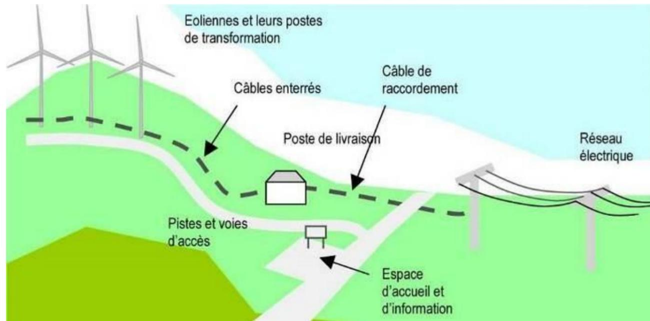
Figure 50 : Schéma de principe d'un parc éolien (Source : Guide de l'étude d'impact sur l'environnement des parcs éoliens, 2010)
