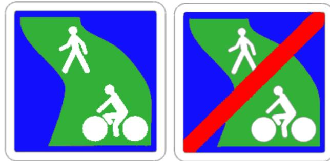
Figure 26 : Panneau d'indication de début de portion en voie verte (C115) à gauche, et panneau de fin d'indication de voie verte (C116) à droite
