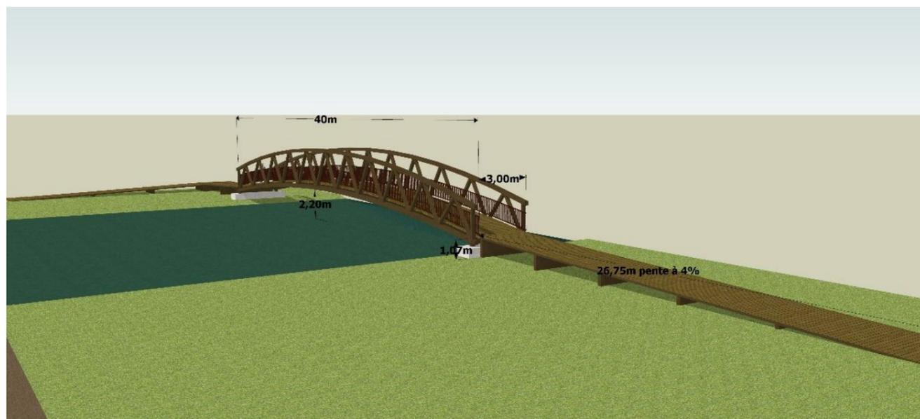
Figure 33: La vue en perspective : la passerelle avec rampes d'accès
