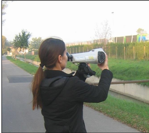
Photographie 2 : Mesure de la concentration d'odeurs à l'aide d'un olfactomètre de terrain
