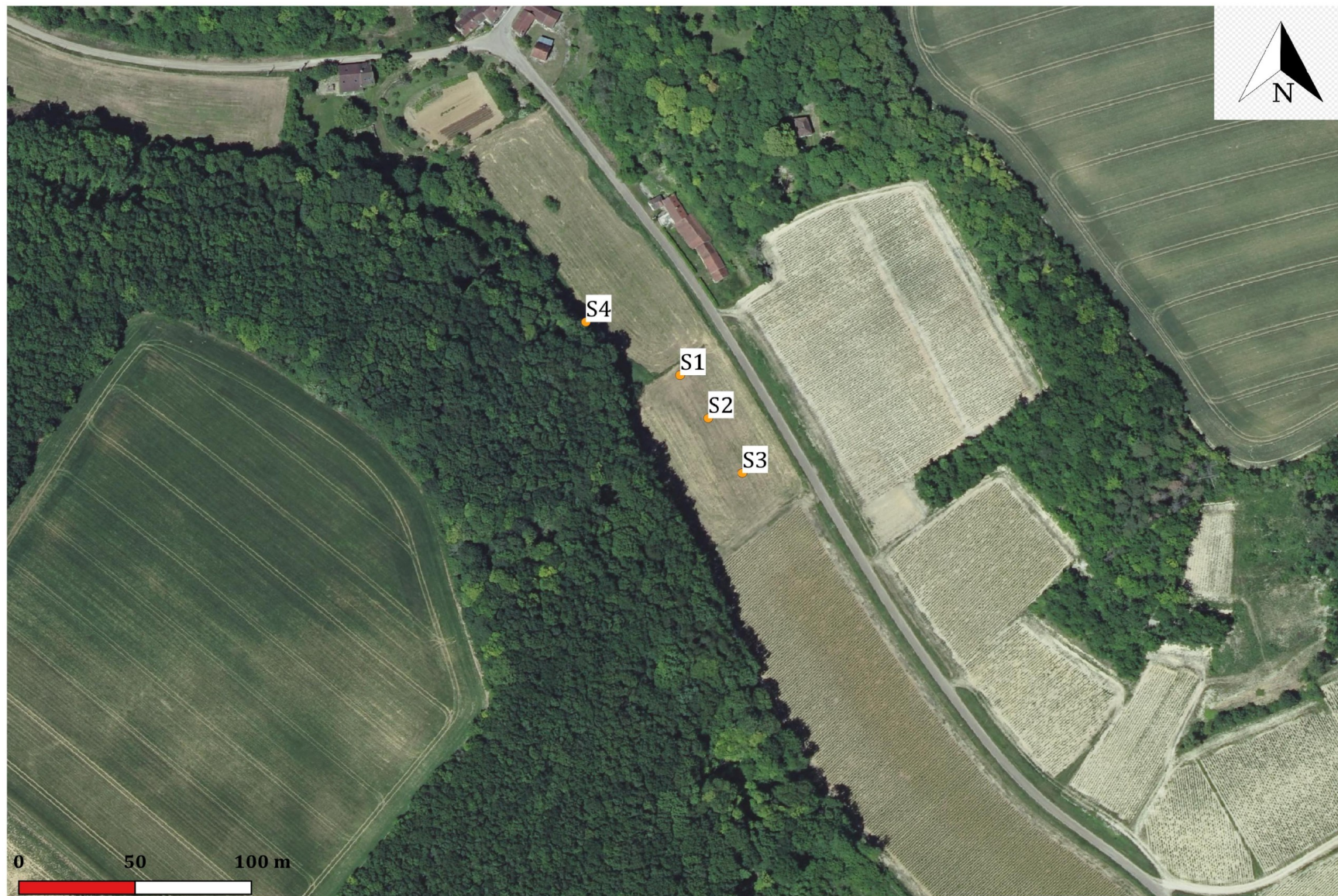
Illustration 8: Implantation des sondages à la tarière pour l'identification de zone humide
