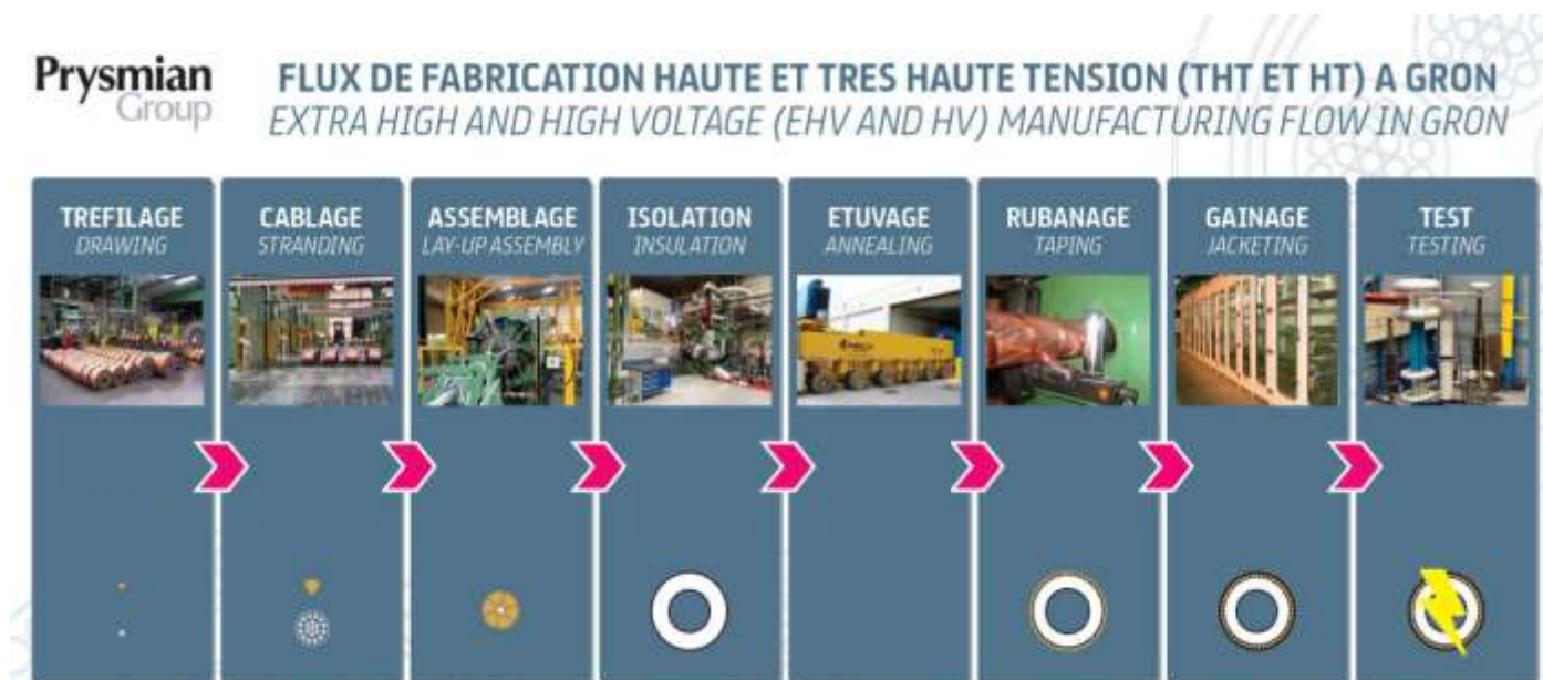
Figure 4 : Phase de fabrication des câbles moyenne tension (source PRYSMIAN)
