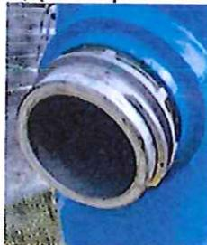
ou sinon, d'un demi-raccord symétrique DN 100 ; veiller au positionnement des tenons, orientés en position « haut et bas », annexe B de la norme NF S 61-701.
