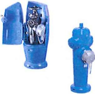
Les poteaux d'aspiration sont de couleur bleue sur au moins 50 % de leur surface visible après pose. Ils peuvent être équipés de dispositifs rétro-réfléchissants. Le bleu symbolise ainsi un appareil sans pression permanente ou nécessitant une mise en aspiration.
