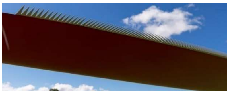
Figure 37: Ajout de dentelures sur une pale d'éolienne afin de limiter l'impact acoustique
