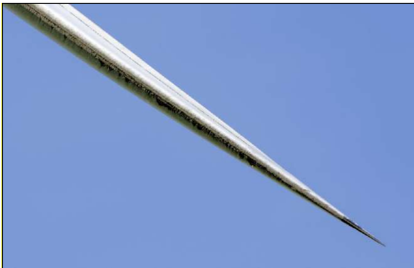
^ Exemple d'usure en bord de pale bien visible sur cette photo.
