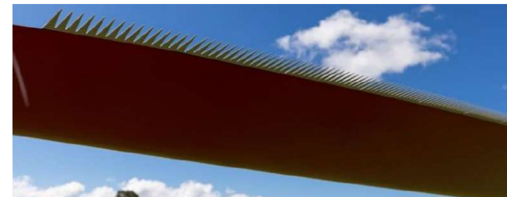
Figure 10 : AJOUT DE DENTELURES SUR UNE PALE D'EOLIENNE AFIN DE LIMITER L'IMPACT ACOUSTIQUE
