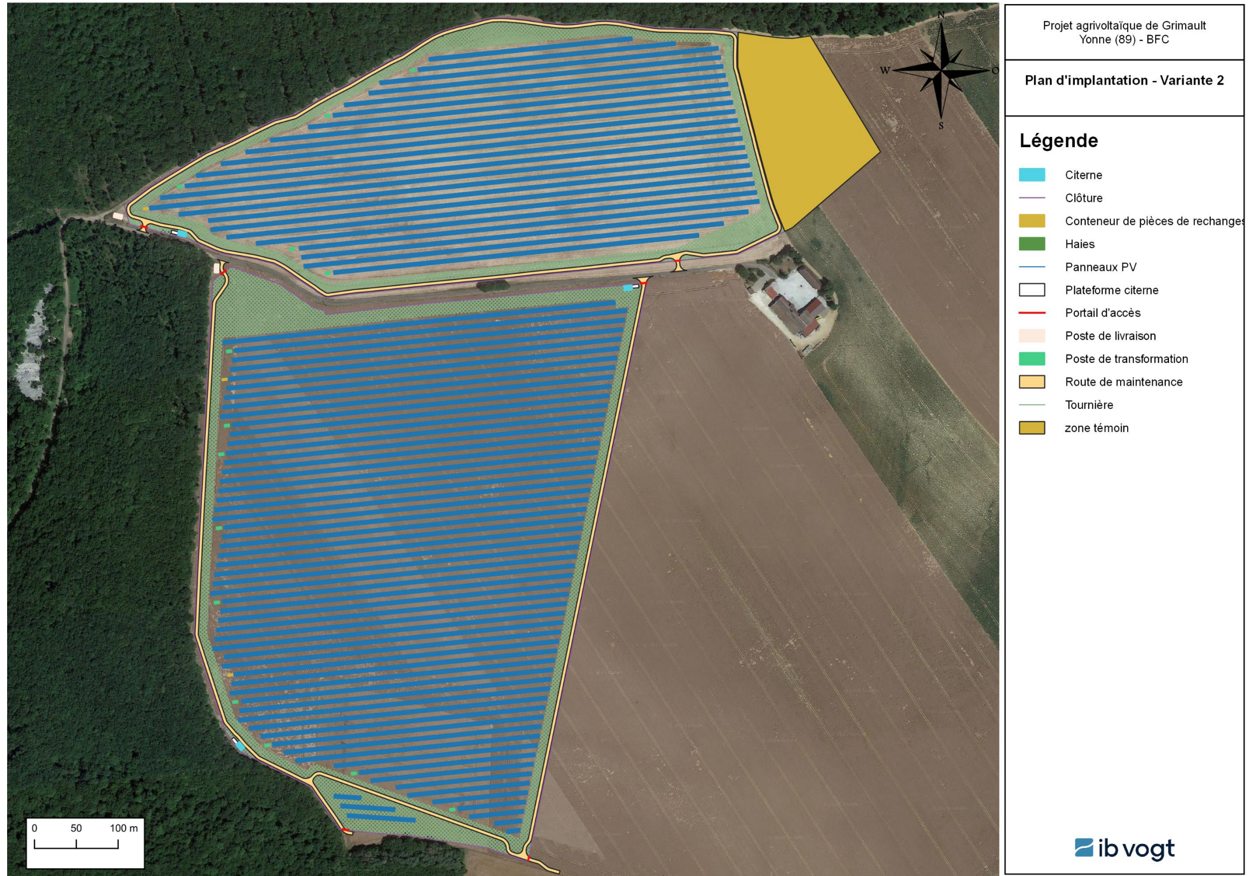
Figure 6 : Implantation finale du projet (source : ibvogt)
