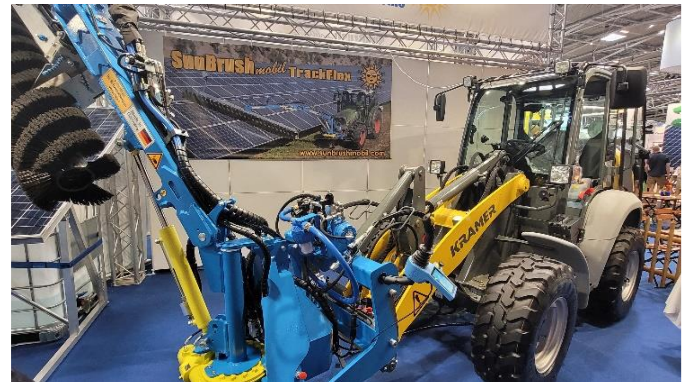
Figure 65. la technologie Sunbrush, attelable à un tracteur
