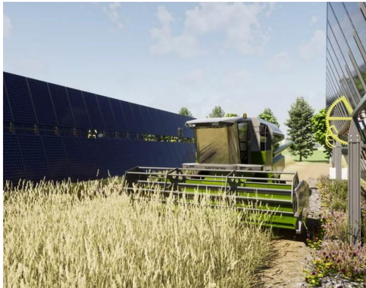
Figure 43. Illustration graphique du mode agriPV avec passage des engins agricoles par le fabricant de trackers IDEEMATEC (Source : IDEEMATEC)
