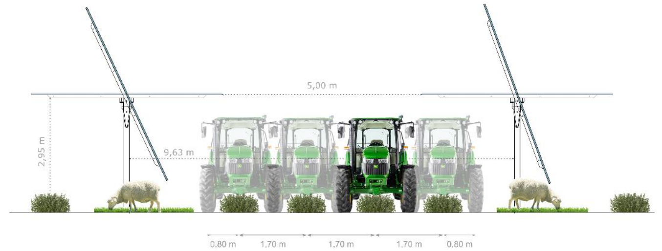
Figure 32. Coupe du projet de productions d'herbes aromatiques en système agrivoltaïque tracker (Source : GLHD)
