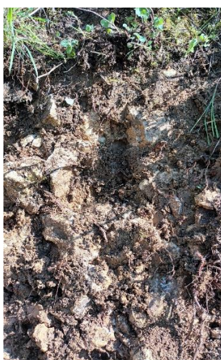
Figure 9 – Blocs de calcaires pris dans une gangue argilo-limoneuse (sol du site d'implantation du futur bassin)
